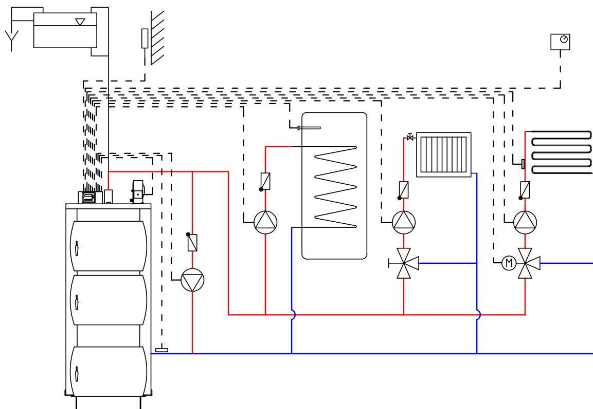
Независимое управление смесительным клапаном с использованием контроллера HT tronic Z3D (опция)
