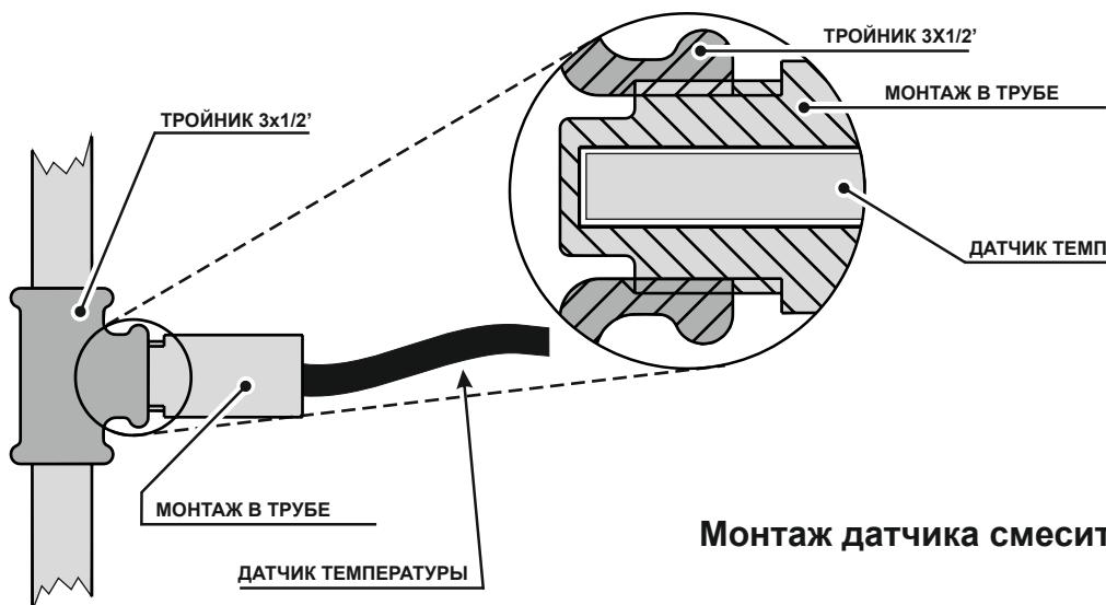
Монтаж датчика смесительного клапана
