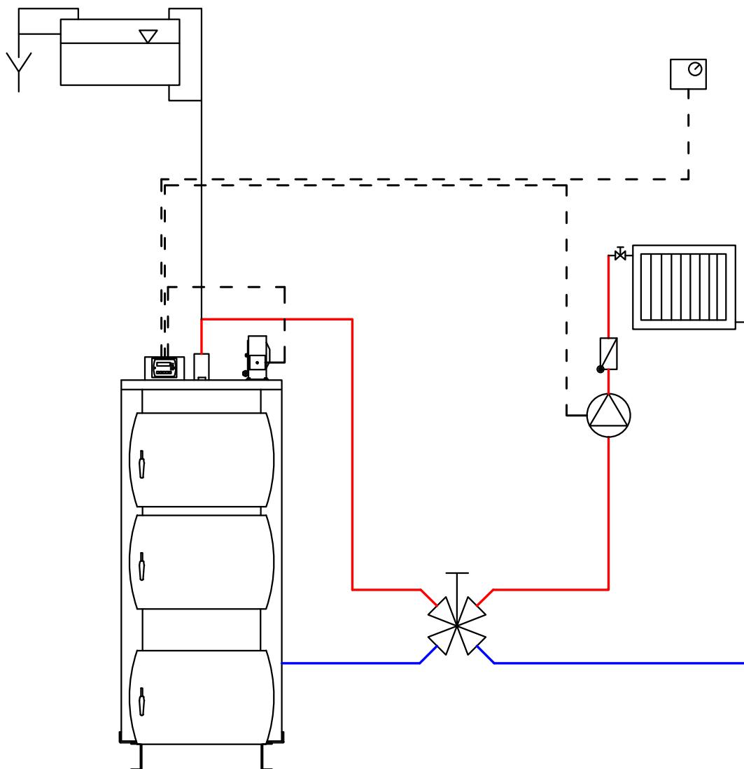
Исполнение с использованием трехходового смесительного клапана и насоса на подмесе обратной линии
